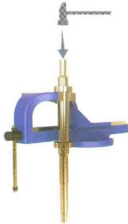
شکل ۲۶- خارج نمودن بلبرینگ از محور
