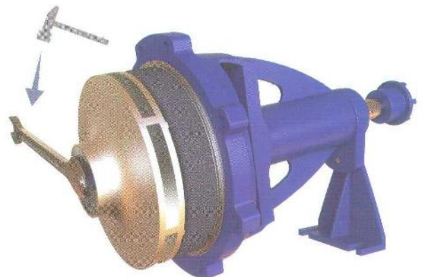
شکل ۲۰- باز کردن مهره شش گوش پروانه
