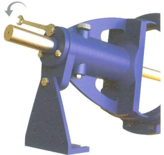
شکل ۲۴- باز کردن درپوش بلبرینگ
