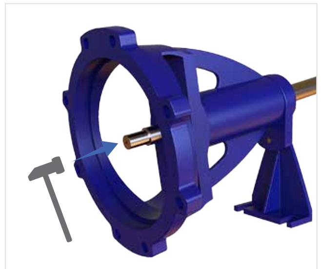
شکل ۲۵- خارج نمودن محور از روی پایه یاتاقان
