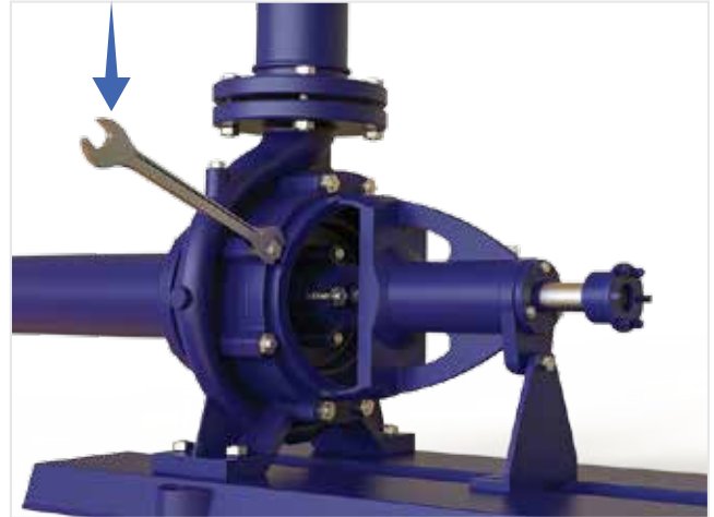
شکل ۱۸- باز کردن مهره های شش گوش محفظه
