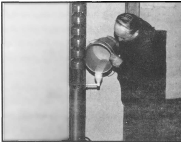
شکل ۱۶- روش آماده کردن الکتروموتور شناور
