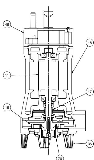
**NOMENCLATURA PARTI DI RICAMBIO****SPARE PARTS LIST****NOMENCLATURE PIECES DE RECHANGE****NOMENCLATURA REPUESTOS****Albero con rotore – Pump shaft + rotor 11
